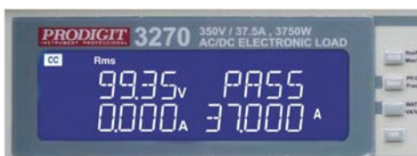
Turbo OFF, Short 100ms 37.5A 测试结果画面
