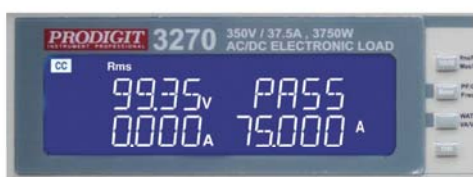
Turbo ON, Short 100ms 75.0A 测试结果画面
