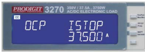
Turbo OFF, OCP Istep 3.75 A Istop 37.5A 测试结果画面
