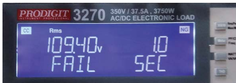
电压 110V 循环次数设定为10次，测试时间 1秒，测试结果Fail ( Trip测试结果未熔断 )
