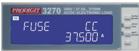
Turbo : OFF, Fuse mode 测试结果画面
