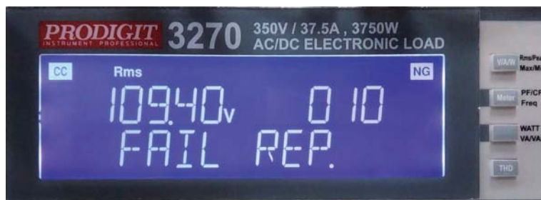
电压 110V 循环次数设定为10次，测试结果Fail ( Trip测试结果未熔断 )
