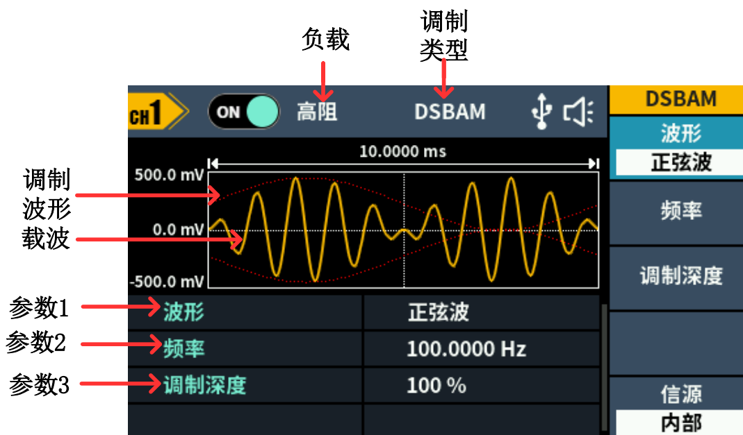
图 5-12: 双边振幅调制的用户界面
