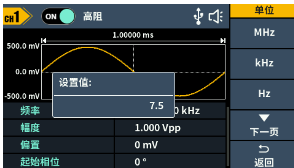
图 5-3：使用数字键盘设置频率
