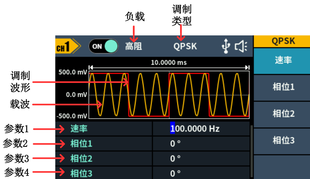
图 5-22 四相相移键控调制的用户界面
