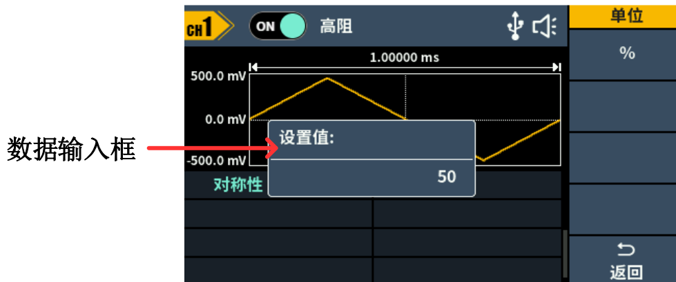
图 5-6: 设置锯齿波的对称性
