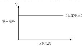
在其它负载模式下,按【V-SET】键进入定电压模式,用【ON/OFF】键启动或停止工作。
