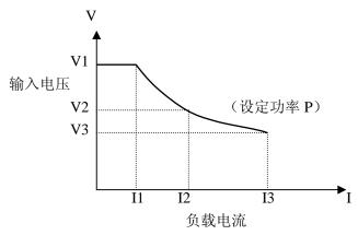
在其它负载模式下,按【P-SET】键进入定电压模式,用【ON/OFF】键启动或停止工作。负载未启动时,可用旋钮改变设定值,或再按【P-SET】键用数字键输入新的值。 ©提示:更改功率设定值请参考 4.1 节方法。
