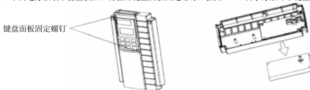
图 1-3-3 卸下键盘面板 ( \leq 22\text{kW} )
