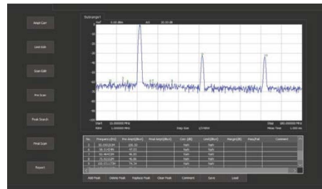
使用提供的 EMI 软件（可在 www.bkprecision.com 上下载）配置频谱分析仪，执行预扫描、峰值搜索、last 扫描，并生成合规前测试报告。
