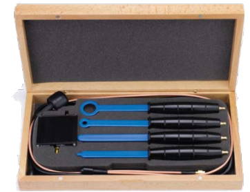
带 40dB 前置放大器的磁 (H) 和电 (E) 近场探头
