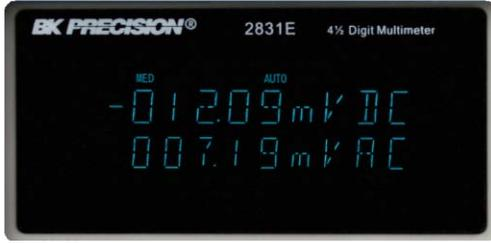
这些仪表提供双显示器，可以方便地同时显示多个测量值。显示值可以是两个不同的测量值或以不同单位表示的一个测量值。例如，您可以同时读取以伏特和分贝表示的交流电压和频率值或直流电压值。
