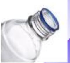
试剂瓶口的倾倒环，倾倒液体时，可防止液体挂壁外溢。
