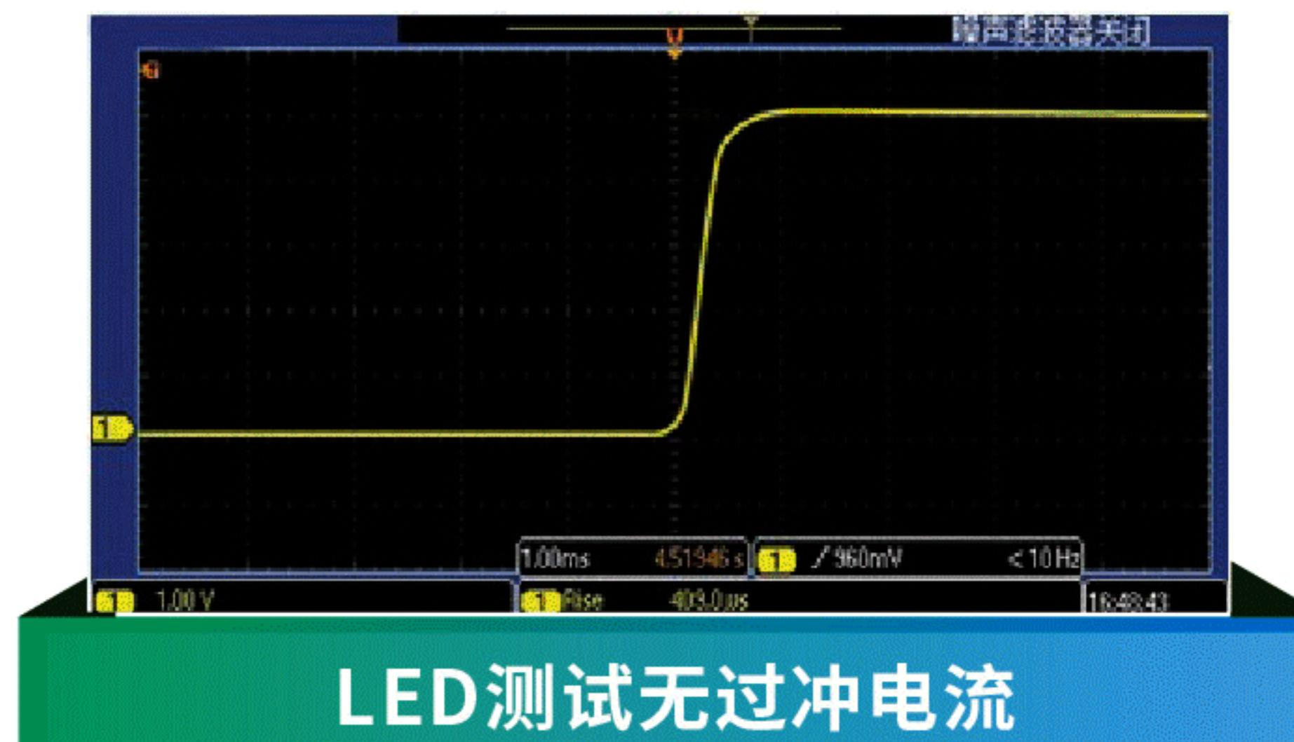
LED测试无过冲电流
