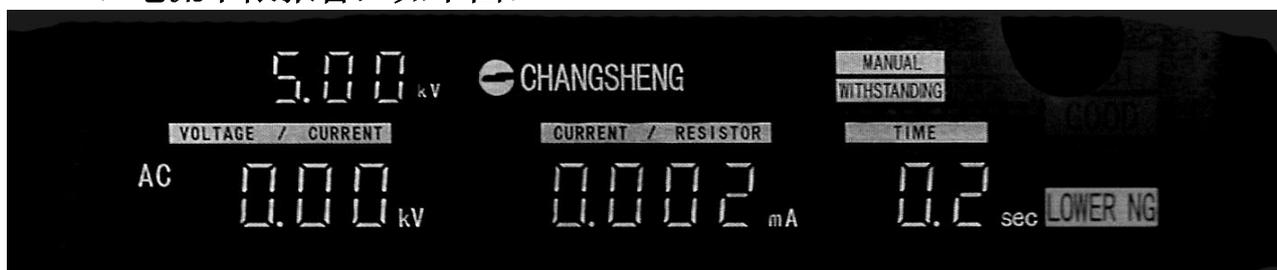
如检测出的漏电流小于漏电流下限设定值，则测试仪立即停止测试，蜂鸣器“嘟——”长
