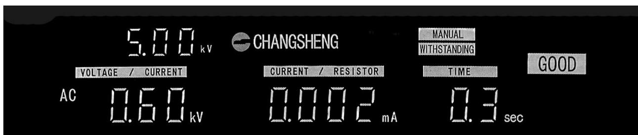
时间参数设置不为 0 时，则测试时间到，测试仪自动停止测试，蜂鸣器“嘟——”响一声并且标志位“GOOD”亮。如测试时间为 0，则没有合格品判定。
