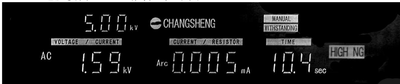
如检测出的 ARC 电弧超限，则测试仪立即停止测试，蜂鸣器“嘟——”连续短响并且标志位警报灯亮。
