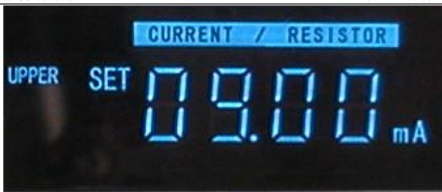
标志位“UPPER SET”亮，并且右边第一位闪烁，表示这一位被选中，可通过按上、下、右键 对上图的四位数进行设定。在设置电流上限的同时，漏电流测量量程也随之确定。当设定值 $\leq 2\text{mA}$ 时，测量范围为 $2\text{mA}$ ，当设定值 $\leq 20\text{mA}$ 时，测量范围为 $20\text{mA}$ ，当设定值 $\leq 99.9\text{mA}$ 时，测量范围为 $100\text{mA}$
