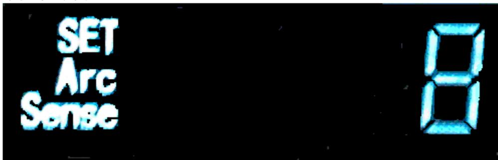
电弧侦测的等级设定是按“ARC”键进入设置模式，标志位“SET Arc Sense”亮。上、下键组合可设定 0-9 级电弧侦测等级，其中，0 级为关闭电弧侦测功能，1 级为电弧侦测灵敏度最低，以次类推，9 级电弧侦测灵敏度最高。
