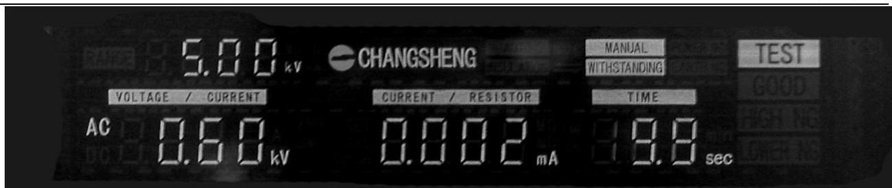
当按下 TEST 键时，测试标志位“TEST”亮，同时高压输出标志亮，测试仪开始测试并输出高压，VFD 显示器显示输出电压值、测试电流值、测试时间值。
