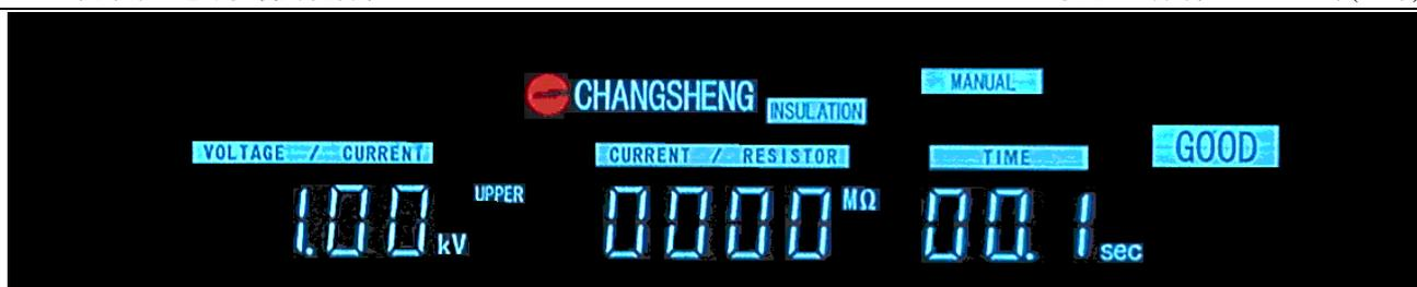
时间参数设置不为 0 时,则测试时间到,测试仪自动停止测试,蜂鸣器“嘟——”响一声并且标志位“GOOD”亮。如测试时间为 0,则没有合格品判定。
