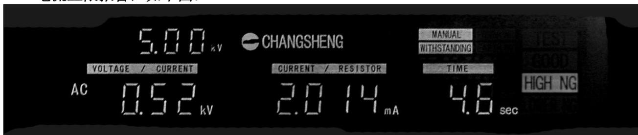
如检测出的漏电流大于漏电流上限设定值，则测试仪立即停止测试，蜂鸣器“嘟——”长响并且标志位警报灯亮。
