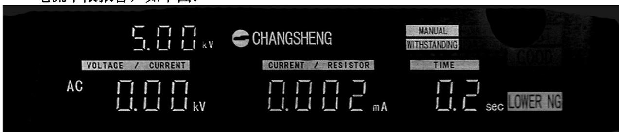
如检测出的漏电流小于漏电流下限设定值，则测试仪立即停止测试，蜂鸣器“嘟——”长响并且标志位警报灯亮。
