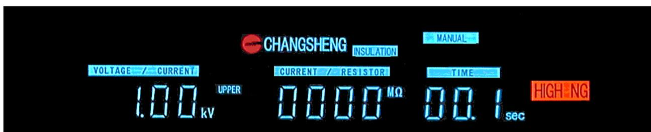
如检测出的绝缘电阻值大于绝缘电阻上限设定值,则测试仪立即停止测试,蜂鸣器“嘟——”长响并且标志警报灯亮。
