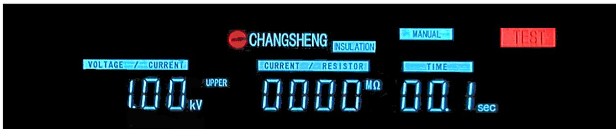
当按下 TEST 键时，测试标志位“TEST”亮，同时高压输出标志亮，测试仪开始测试并输出直流电压，VFD 显示器显示输出电压值、测试电阻值、测试时间值。
