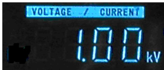
电压右边第一位闪灭，表示这一位被选中，可通过按 **上、下键** 选择测试电压。
