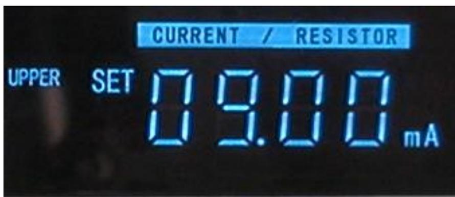
标志位“UPPER SET”亮，并且右边第一位闪烁，表示这一位被选中，可通过按上、下、左、右键对上图的四位数进行设定。在设置电流上限的同时，漏电流测量量程也随之确定。当设定值 $\leq 2\text{mA}$ 时，测量范围为 $2\text{mA}$ ，当设定值 $\leq 20\text{mA}$ 时，测量范围为 $20\text{mA}$ ，当设定值 $\leq 99.9\text{mA}$ 时，测量范围为 $100\text{mA}$ 。
