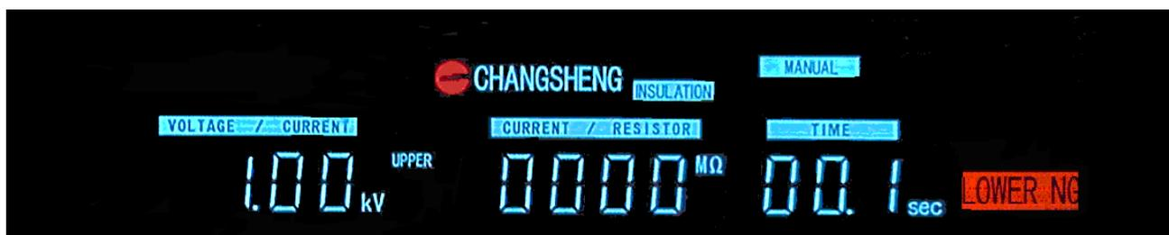
如检测出的绝缘电阻值小于绝缘电阻下限设定值,则测试仪立即停止测试,蜂鸣器“嘟——”长响并且标志警报灯亮。
