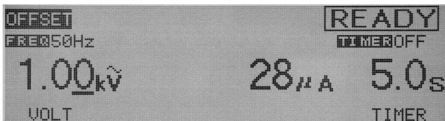
4. 如果有需要，可以在 ACW1 界面中设置测试频率，测试电压和测试时间；
