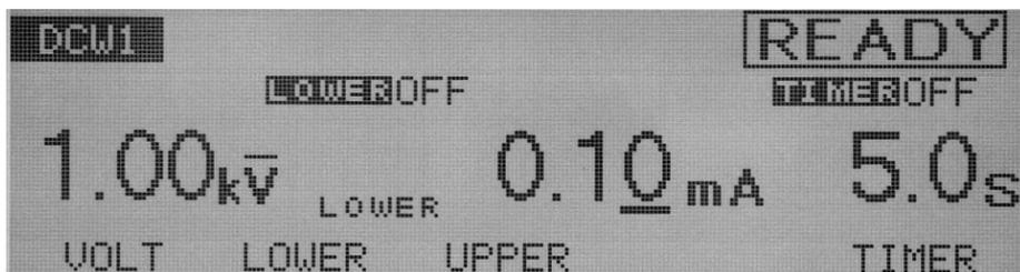
下限电流可以被设置在 0.01mA 到 11mA 之间（在 0.01mA 到 9.99mA 之间的分辨率为 0.01mA，在 10.0mA 到 11.0mA 之间分辨率是 0.1mA）。
