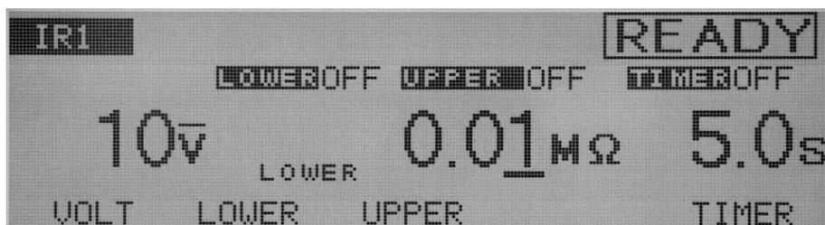
电阻下限可以设定在 0.01 MΩ 到 9.99 GΩ 之间(在 0.01MΩ 到 9.99 MΩ 之间以 0.01 MΩ 的分辨率，在 10MΩ 到 99.9 MΩ 之间以 0.1MΩ 的分辨率，在 100MΩ 到 100MΩ 之间以 1MΩ 的分辨率，在 1GΩ 到 9.99 GΩ 以 0.01GΩ 的分辨率)，但要在最大额定电流范围内。当在等待时间过后检测到电阻值等于或者小于下限电阻的时候，测试结果判断为 FAIL。当光标指示在在下限电阻上时，可以旋转旋钮进行设定。
