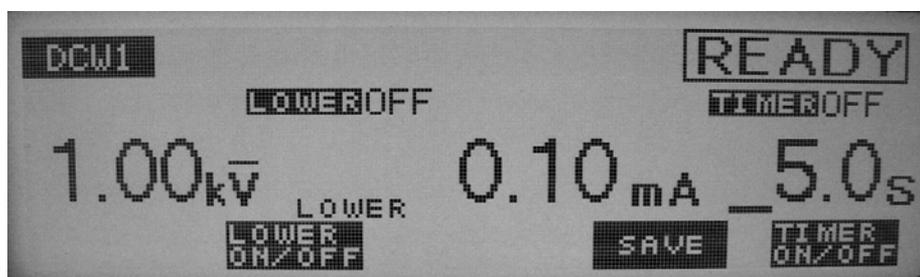
当定时功能开启，测试时间受下节中显示的“测试时间设置”的设定时间控制。当测试时间达到，而漏电流在下限电流和上限之间，那么测试结果就判断为合格。
