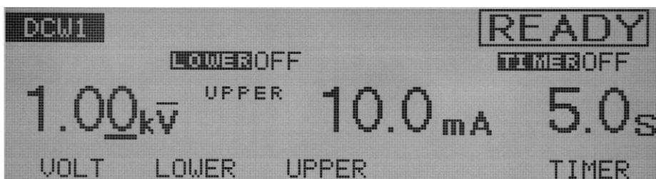
应用到被测件上的测试电压可以被设置在直流 0.00kV 到 6.10kV 之间（以 0.01kV 的分辨率）。
