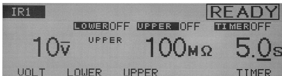
加到被测件上的测试电压的时间可以被设定在 0.3 s 到 999s 之间（在 0.3s 到 99.9s 之间以 0.1s 的分辨率，在 100s 到 999s 之间以 1s 的分辨率）。
