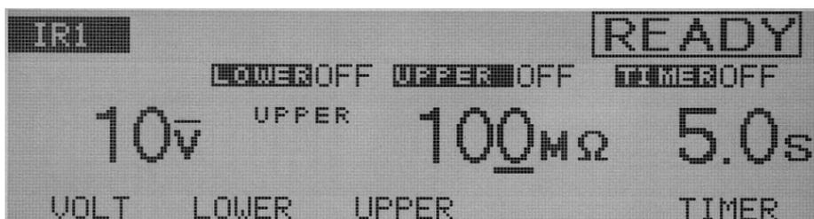
上限电阻可以设定在 0.01 MΩ 到 9.99 GΩ 之间(在 0.01MΩ 到 9.99 MΩ 之间以 0.01 MΩ 的分辨率，在 10MΩ 到 99.9 MΩ 之间以 0.1MΩ 的分辨率，在 100MΩ 到 999MΩ 之间以 1MΩ 的分辨率，在 1GΩ 到 9.99 GΩ 以 0.01GΩ 的分辨率)，但要在最大额定电流范围内。当光标指示在在下限电阻上时，可以旋转旋钮进行设定。
