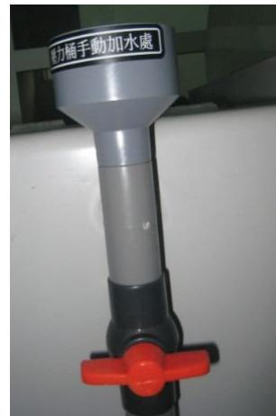
4、水封：将密封水槽加水至垫板位置，以起到隔绝试验室的水封作用；
