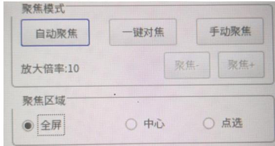
聚焦一共分为三种模式，分别对应不同场景下的操作；相机放大倍率为 10—140 倍，使用相机时需注意，相机的物距在十公分以上才能清晰的聚焦成像。按照物距 400mm，在 21 寸显示器显示为例：最小倍率时视野范围为 310mm 0.65X 最大倍率时视野范围为 38mm 3.3X
