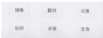
1) 相机图像调整设置：开机后根据图形方向，选择是否需要镜像翻转（**镜像**：图形进行左右翻转 **翻转**：图形进行上下转换。）；**设置**（包含：版本更新，语言选择，图片保存格式，版本号）；**拍照抓图**（当插入U盘时，单击拍照按钮即可将图像保存至U盘）；**录像**（需插U盘，点击录像后开始录制，录制按钮开始闪烁红色则开始录制，开始后可进行倍率变化等操作，当录完视频后，再次点击录像，即可结束录制。）；**查看**（查看U盘或本地相机保存的照片）。
