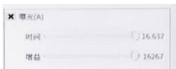
2) 曝光设置：设置曝光时间，曝光时间越长，图像亮度越亮；调整图像亮度增益，图像增益越大，图片显示亮度越高，但是增益增加的同时，图像锐度会
