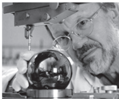
图4 CSIRO科学家加工的高纯度硅球
