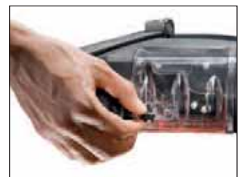
持续的冷凝水排空便于长期测量
