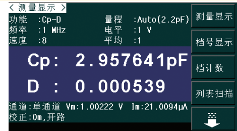
陶瓷电容的高速高精度测试
