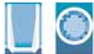
C Starwell C 型星型孔平底带曲边以及 8 个肋 C Starwell C8 星型孔图中显示 8 个肋的方向
