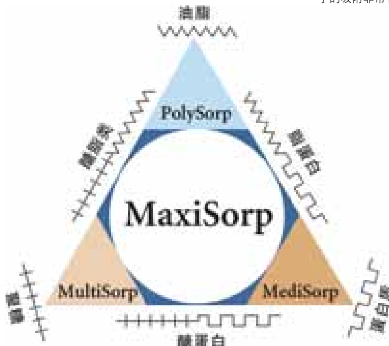
生物大分子与不同表面结合的示意图。例如要结合油脂，疏水性的 PolySorp™ 最适合的。对于具有不同生理化学特性的复杂生物分子，可以选择结合有不会参与到样品或化验试剂反应的生物分子的表面。图表中显示，MaxiSorp 由于具有结合几种类型的生物分子的能力，因而适合的应用范围最广。
