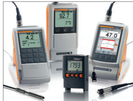
ISOSCOPE®, DELTASCOPE® 和 DUALSCOPE® 手提式仪器, 配有内置探头或外置独立探头, 可在现场快速简便测量涂镀层厚度
