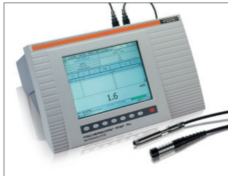
FISCHERSCOPE® MMS® PC, 通用测量平台系统, 可采用磁感应、电涡流和β背散射法进行涂镀层厚度测量和常见材料测试
