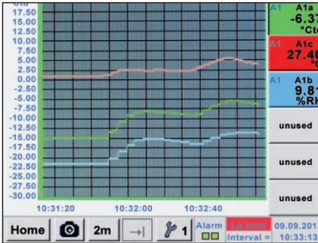
以图表显示测量曲线, 这样有实际经验的人可全面了解自开始测量起干燥机的状态。
