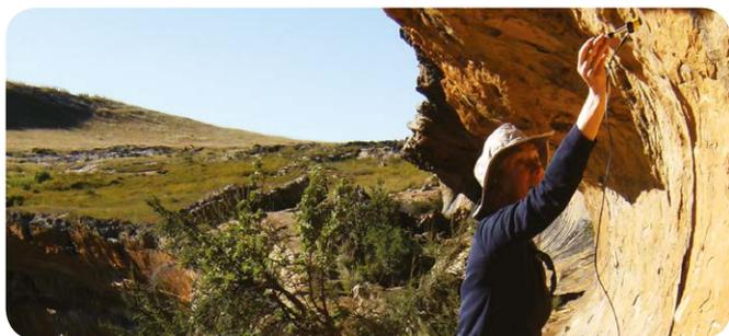
广泛用于测试岩石硬度和岩石风化影响研究 冲击能量约为 N 型回弹仪的 1/200。这非常适合测试历史遗迹（无法
