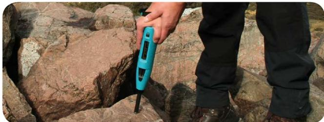
世界上最先进的回弹仪，具备无以伦比的离散特性、耐久性和测量范围，现已完全适用于岩石测试。回弹仪的以下特性使之非常适合岩石测试应用：
