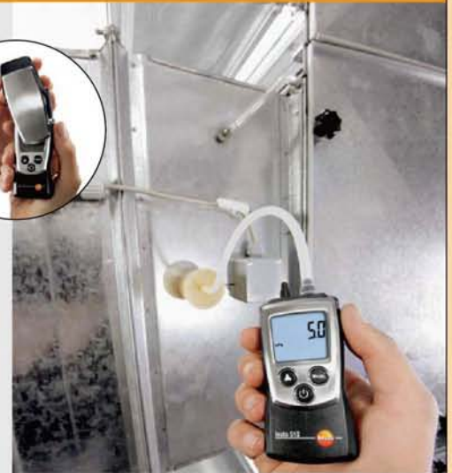
测量过滤器的差压
