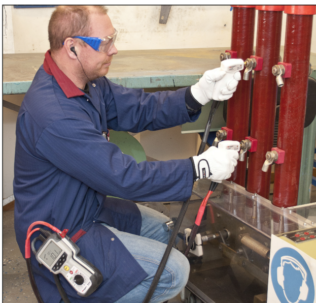
将探头或开尔文夹连接到断路器上，按下trig/TEST按钮。有一个信号指示测试通过或失败，测试结果被记录在仪器内，稍后可存储到电脑。
