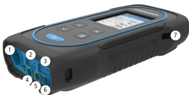
1. Min-DIN 接口,用于连接  $CO$  和  $CO_2$  环境探头
