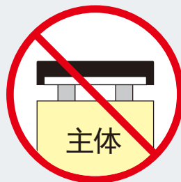
主体悬空安装
