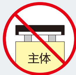
主体悬空安装
