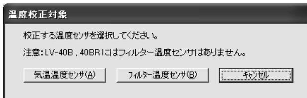
以下の内容が表示されたら、[温度読出] ボタンをクリックし、基準温度を入力して [合わせ] ボタンをクリックします。合わせ後、再度 [温度読出] ボタンをクリックすると、校正後の値が表示されます。[合わせ] ボタンをクリックする前に [キャンセル] ボタンをクリックすると校正を中止します。
