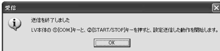
注意)設定を送信すると自動的にPCのシステムクロックにLVのクロックを合わせます。
