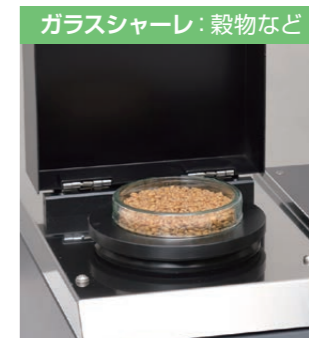
ガラスシャーレ: 穀物など 粒、粉、ペースト、形状が不均一なもの等に適しています。
