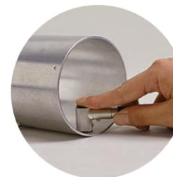
測定は、測定箇所にプローブを垂直に押し当てますが、筒や鉄骨の内側など、測定箇所が狭い場合、標準プローブは長すぎて垂直に押し当てられません。そのような場合に、垂直に押し当てられるオプションのL字型プローブです。
