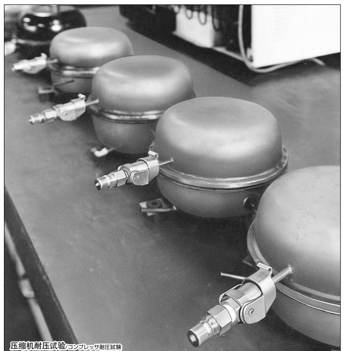
压缩机耐压试验/コンプレッサ耐圧試験
