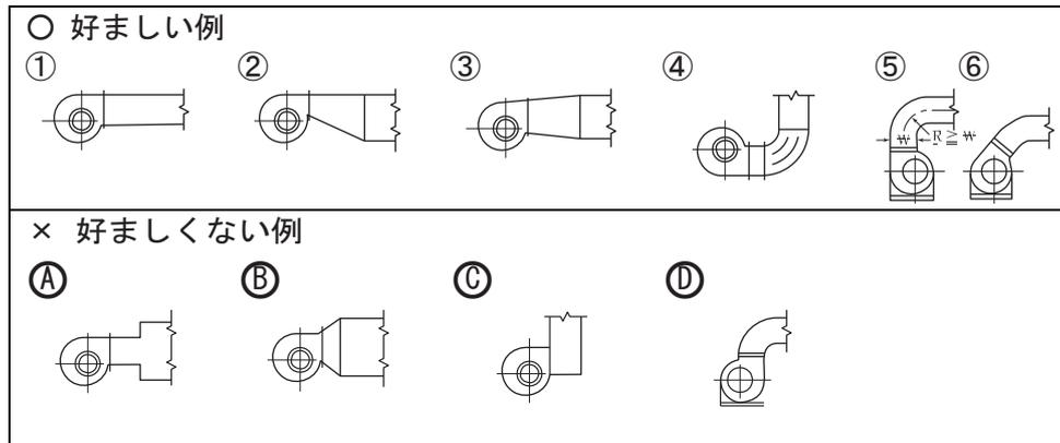
◆ドレン排出口が付いている製品は確実に排出するように配管してください。不完全な場合は床や壁を汚す原因となります。また、排出がスムーズにされないと、ケーシング内に水などが溜まり、始動時にモータの過負荷に繋がり焼損などの故障の原因となる可能性があります。
