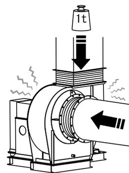
**⊘** ダクトの荷重を送風機に伝えないでください。ダクトの荷重を送風機に伝えると送風機が変形し、回転部が接触して、火災や破損事故の原因となります。また耐熱形送風機については、高温によりダクトが伸びるため、吸込側、吐出側とも必ず伸縮継手を使用してください。
