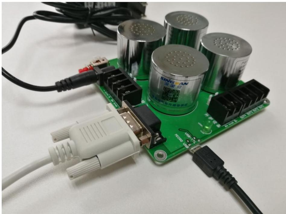
深国安智能型二氧化硫传感器 (SGA-700B-SO2) 具有的特点为产品采用本质安全型电路设计可带电热拔插操作, 也兼容红外、电化学、催化、半导体、PID 等不同原理传感器, 且深国安出厂的智能传感器任何气体尺寸统一、信号统一、用法统一。
