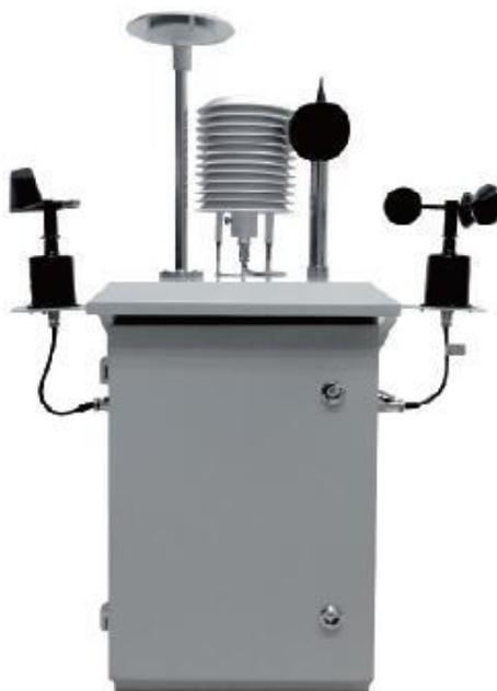
根据需要网格化大气环境监测仪上还配备有液晶显示，实时显示监测的气体浓度。另外，还配置了 485 无线传输模块，可以将监测到的数据实时传输到用户后台软件中兼容，实现对监测数据的实时查看等。当然也可以使用深国安专属定制的专用软件。后台可以实时查看监测数据，对生成的数据进行曲线显示、导出、打印、存储等。监测数据一目了然。
