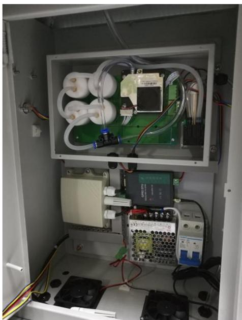
深国安大气环境监测仪的安装也非常方便。四气智能传感器模组出厂前已经插上，PM2.5、PM10、温湿度、无线模块、吸气泵等跟随电路板已经安装完毕，用户收到深国安的大气环境监测仪，一般只需要安装风速、风向、抱箍固定。风速风向的插头一看就知道安装的位置。另外，采样头的安装，也只是需要拧紧螺丝便可，非常方便。
