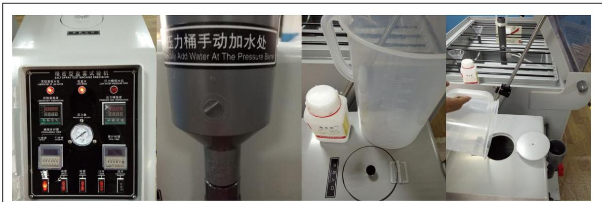
盖子打开，在盖子密封槽里加清水密封盖子，然后把测试的产品放在 V 型槽上，摆放角度要求 15 度角或 30 度角，产品放好后，盖子手动关上。
