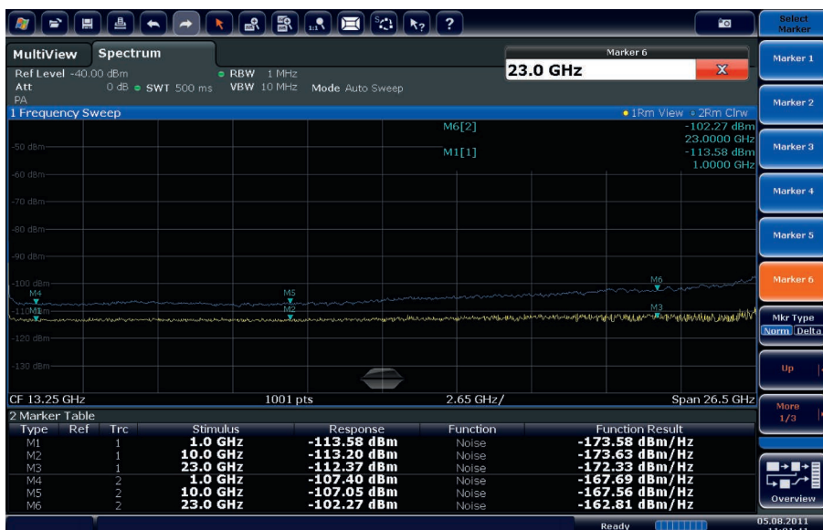
预放和噪声消除打开时的显示平均噪声电平 (DANL)。
