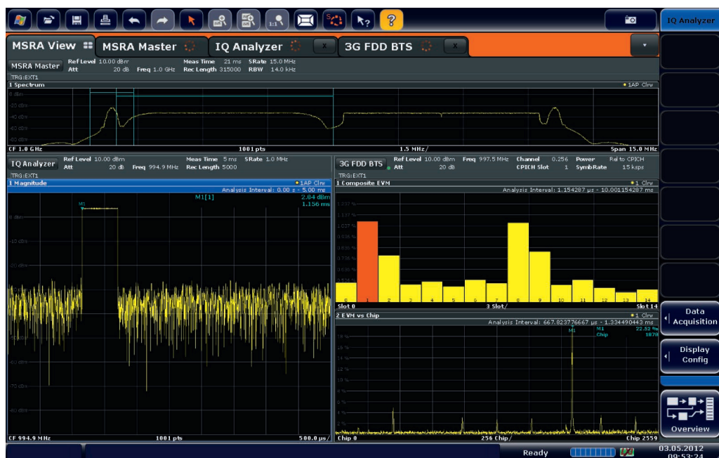
多标准无线分析仪 (MSRA): 一次性捕获信号，然后根据不同标准，在不同频率并行分析
