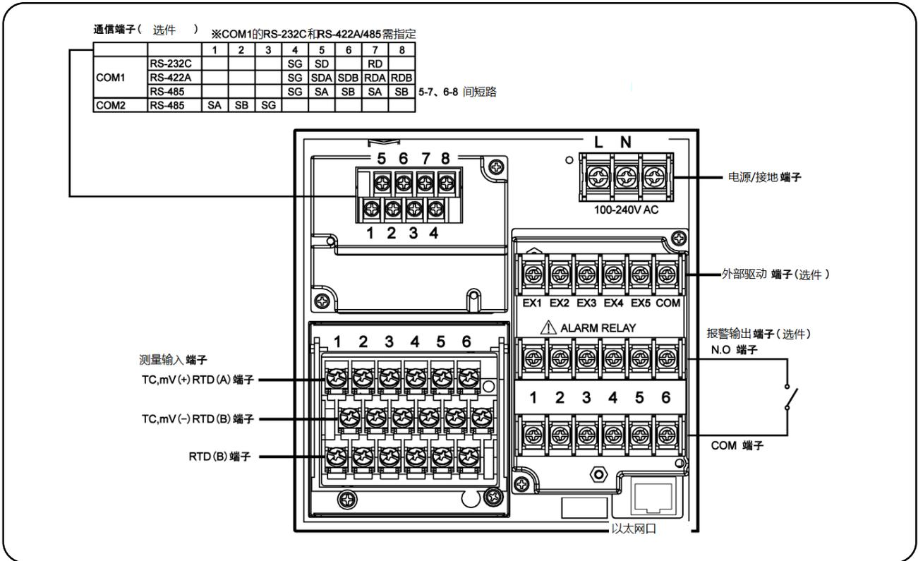
下图是装配选项 [报警继电器输出 (4点c接点) + 外部驱动、通信接口] 的端子板图。
