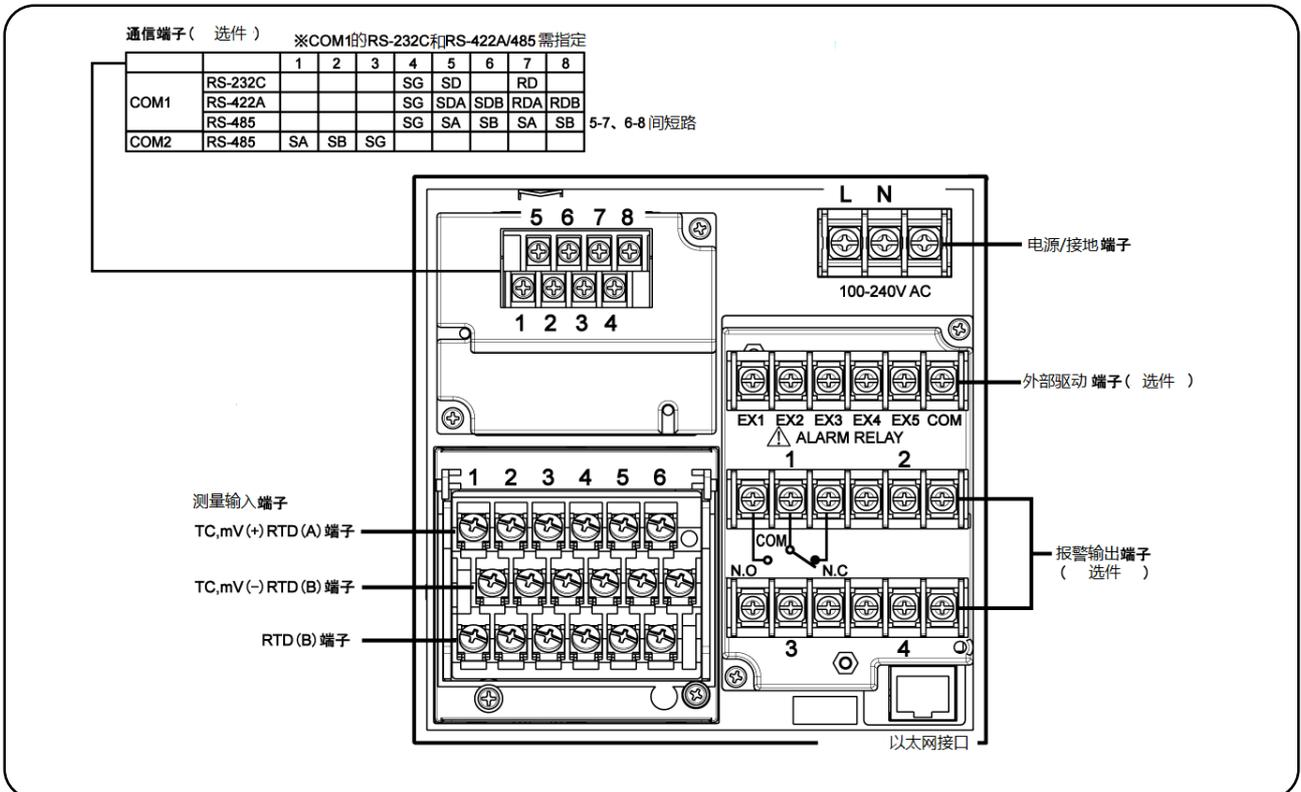
下图是装配选件 [报警继电器输出(2点 a 接点)、通信接口] 的端子板图。
