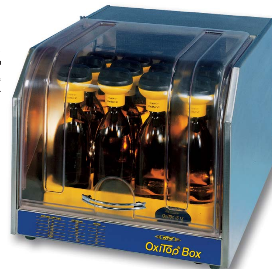
应用示例：内装一套遥控BOD测试仪 OxiTop Control 12
