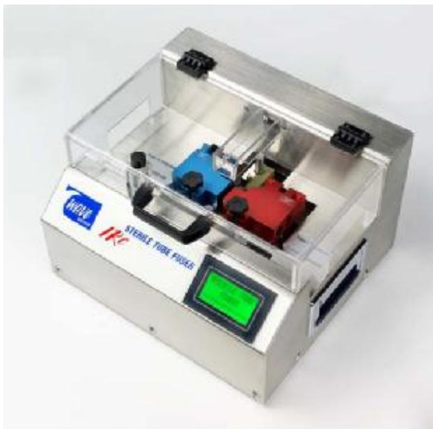
Sterile Tube Fuser (STF) 硅胶管焊接机可以在不需要无菌环境的条件下，对各类常用的热塑硅胶管进行无菌切割和连接（焊接），使生物工程液体可以在不同的容器之间快速、安全地进行自由流通，而不用担心因管道连接而造成的细菌污染。STF 硅胶管焊接机是全自动工作的，只要安装好切割刀，固定好需要连接的两根管道，盖上盖子后启动机器，大约 3~4 分钟左右，两根管道即可被牢固地连接在一起，并且确保是无菌连接，具体的工作过程如下图所示。
