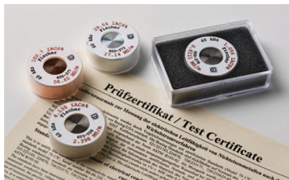
认证标准块用于 SIGMASCOPE® SMP350, 可追溯到国际认可的校准规范
