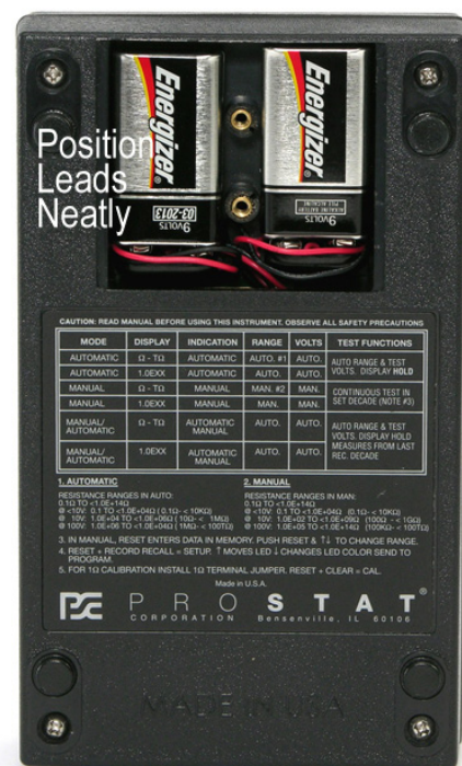
图 4：安装两节9V碱性电池
