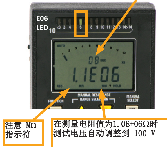
图 13: 在测量 1.0E+06\Omega 到 <1.0E+14\Omega 范围电阻值时，
