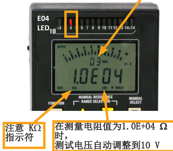
图 12: 在测量 1.0E+04\Omega 到 <1.0E+06\Omega 范围电阻值时，测试电压将自动调整到10V
