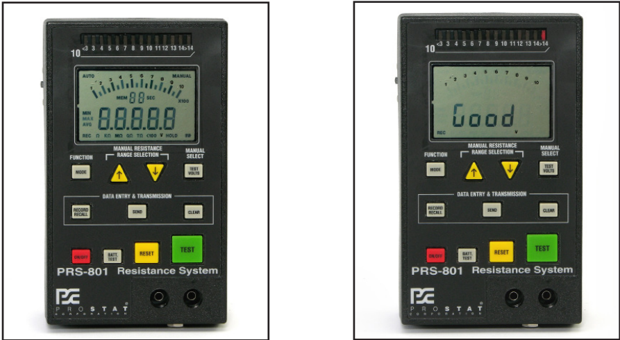
图 10: PRS-801被开启后，自动检测显示屏功能，LED指示器和电池电量
