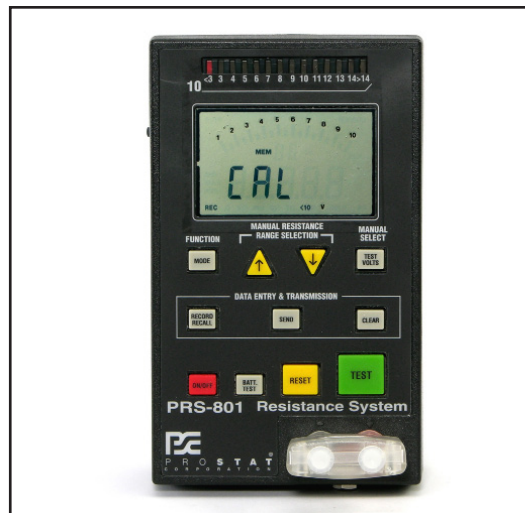
图 7: 开始校准 在0.5秒内相续按 RESET键 和CLEAR键
