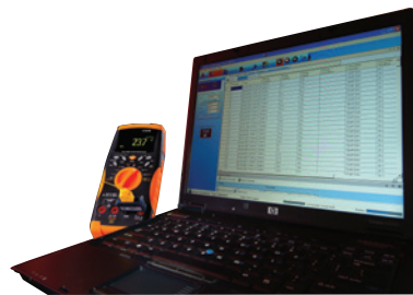
图 1：使用随机配备的图形用户界面 (GUI) 数据记录软件自动记录测量结果
