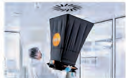
testo 420专业风量罩 大型涡流出风口风量、温度和相对湿度测量
