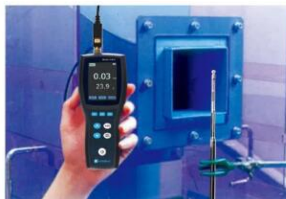
管道出风口测试
