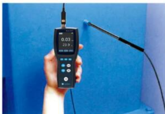
管道内风速、风量测试
