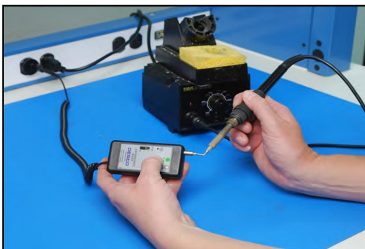
检测烙铁头接地
