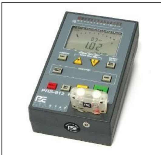
图6：使用参考模块进行低电阻范围校准
