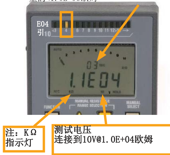
图11：自动中 1.0 \times 10^4 至 < 1.0 \times 10^6 欧姆的10伏下的测试电压
