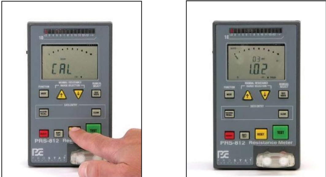
图8：按复位，完成校准顺序。要确认校准，请按测试以测量校准并联电阻。并联电阻应显示出来
