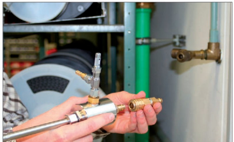
通过测量腔室和预过滤器，连接testo6651使用压力露点探头。
