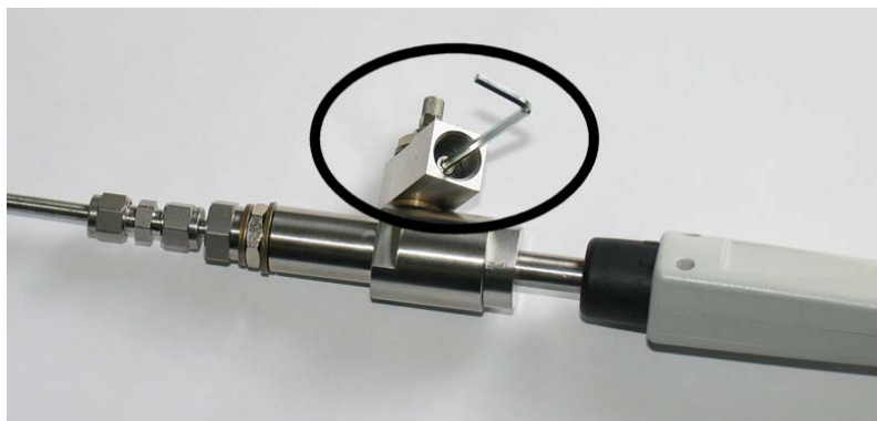
图30 通气量调整螺钉的拆卸
