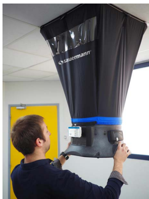
现场操作风量仪
