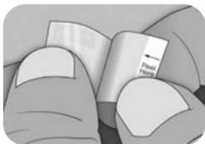
2. 根据被测表面的期望轮廓高度，选择适当级别的复制胶带，参考以下图表：
