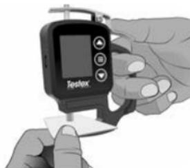
**注意:** 在打开测量仪电源、归零（第 5 页）之前，或在测量后取下复制胶带时测量仪不显示 -50微米 (-2.0 密耳) 时，请清洁砧座。
