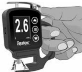
**注意:** 取下复制带后，仪器应返回到 -50 微米 (-2.0 密耳)。如果在测量和取下复型带后显示的数字不同，请按照上述步骤清洁砧座。
