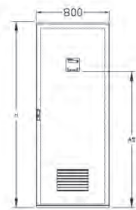
ES8206 (dimensions in mm): H = 2,020, W = 800, D = 600, A1 = 537 A2 = 63, A3 = 737, A4 = 62, A5 = 1,480
