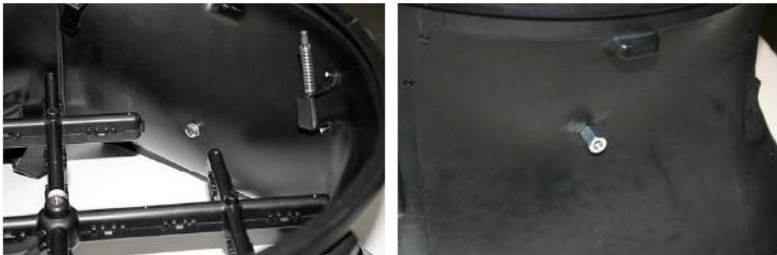
图 23 去掉安装在底座后面的塞子
