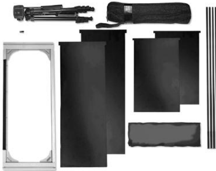
图 22 直接流入测试测试罩组成
