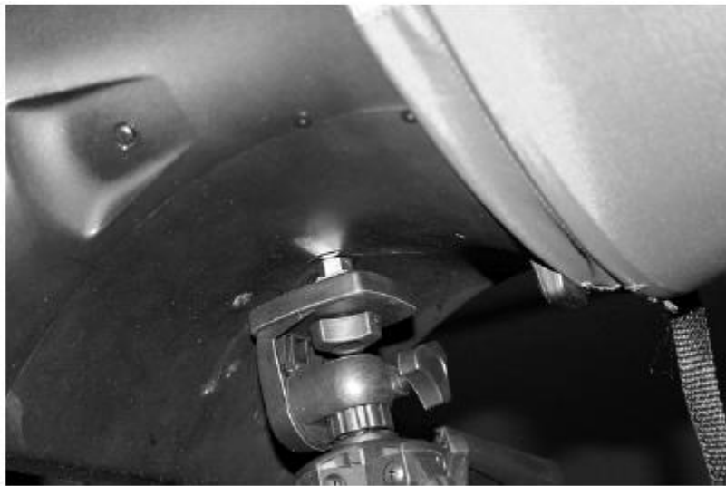
图 25 将微压风速计底座安装到伸缩支撑杆上
