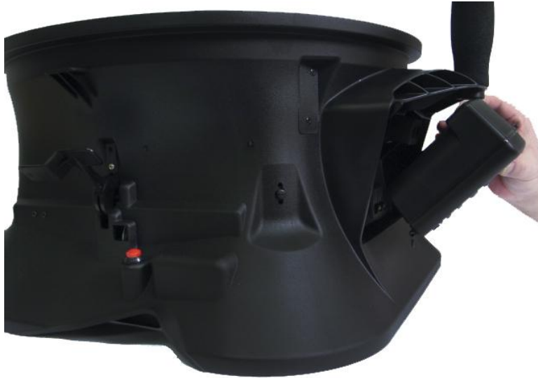
图 10：连接仪表到风量罩底部
