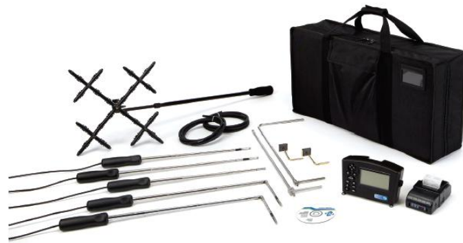
DP-Calc™8715 型微压风速计
